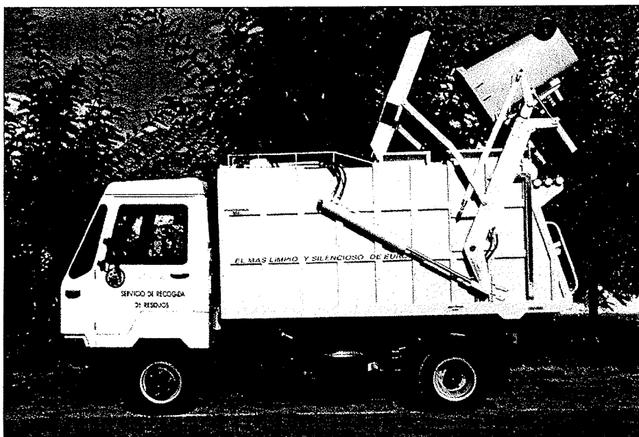
CAMION MULTICAR CON MOTOR VOLKSWAGEN, EQUIPADO CON PRENSA Y ELEVACONTENEDORES, ADQUIRIDO POR EL AYUNTAMIENTO DE GUMIEL DE IZÁN PARA LA RECOGIDA DE RESIDUOS.
